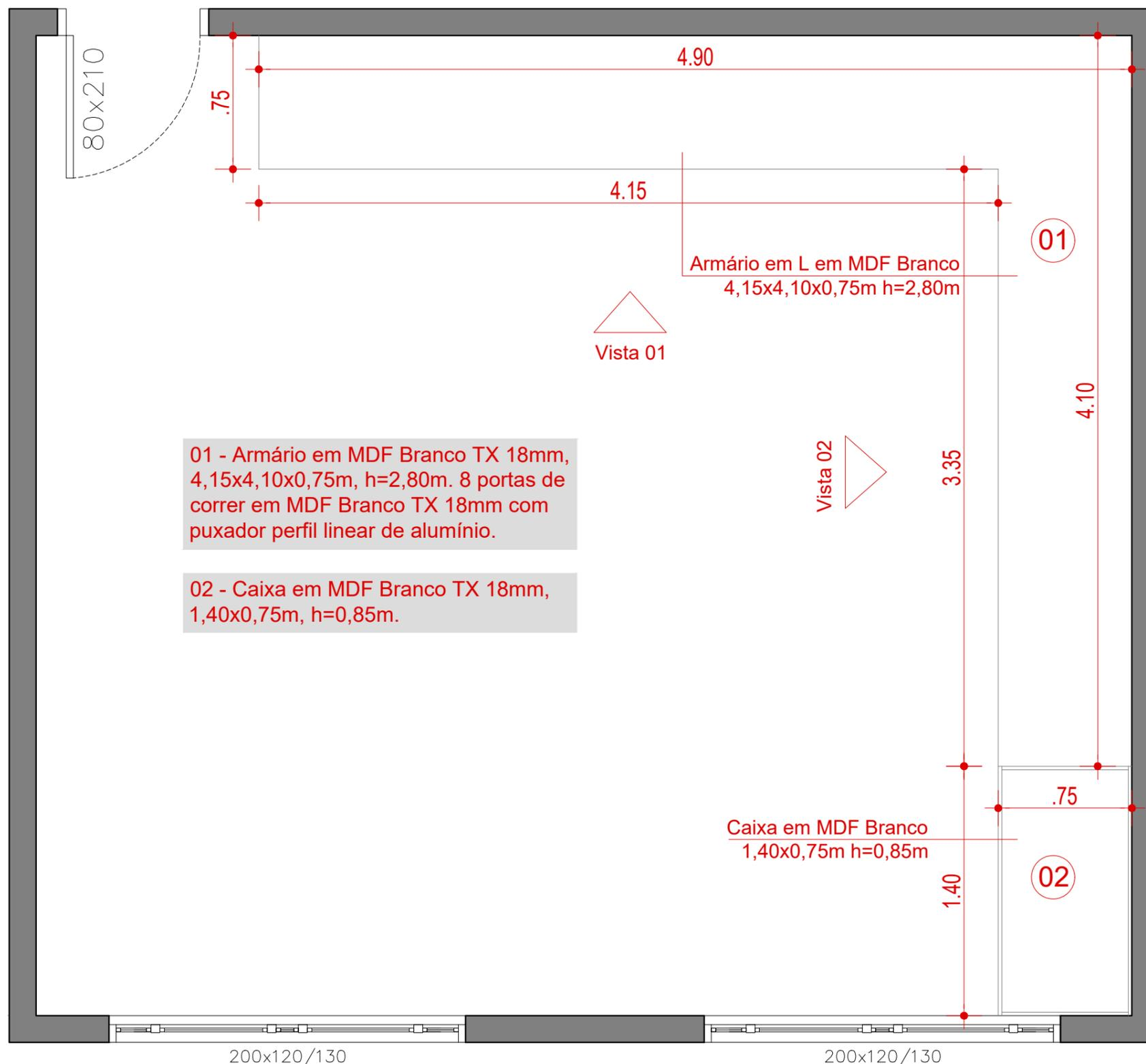
01 - Armário em MDF Branco TX 18mm, 4,15x4,10x0,75m, h=2,80m. 8 portas de correr em MDF Branco TX 18mm com puxador perfil linear de alumínio.
