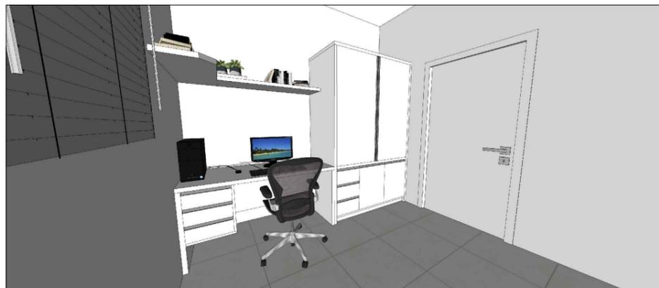
01 - Mesa em MDF Branco TX 18mm, 1,50x0,70x0,75m. Tampo e laterais em MDF Branco TX 36mm. 3 gavetas (0,36x0,15m) com espessura de 18mm, com correijas telescópicas e puxador perfil linear de alumínio. Gavetas lado esquerdo.
