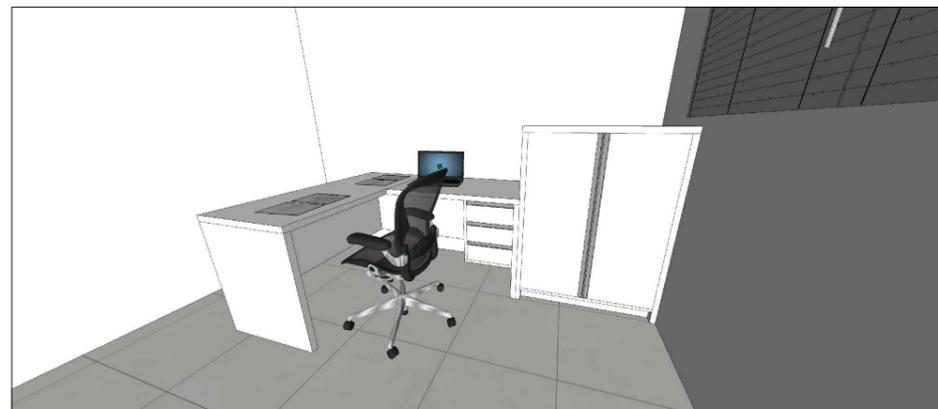
06 - Armário em MDF Branco TX 18mm, 0,90x0,60x1,20m. Tampo e laterais em MDF Branco TX 36mm. 2 prateleiras internas em MDF Branco TX 18mm. 2 portas com espessura de 18mm, dobradiças 35mm com amortecedor e puxador perfil linear de alumínio.
